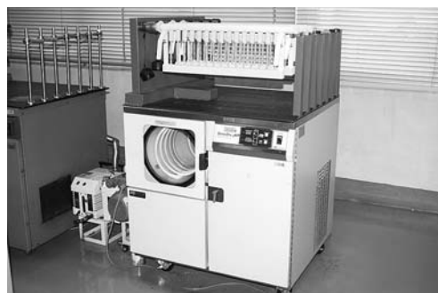
図3 理研型凍結乾燥装置(特願昭59-141735号)
