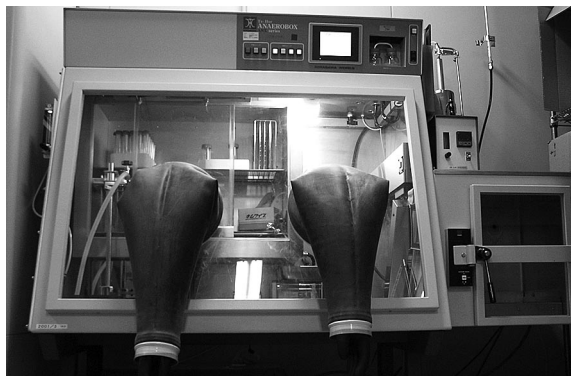
図2 ヒラサワ社製嫌気グローブボックス
