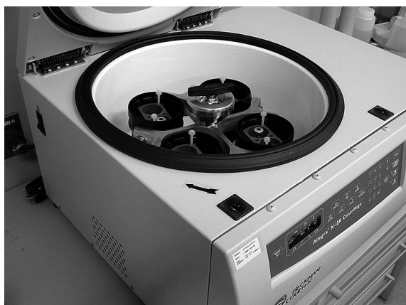
図3 ベックマン社製多機能小型遠心機
