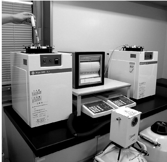
図2 プログラムフリーザーと温度記録計
